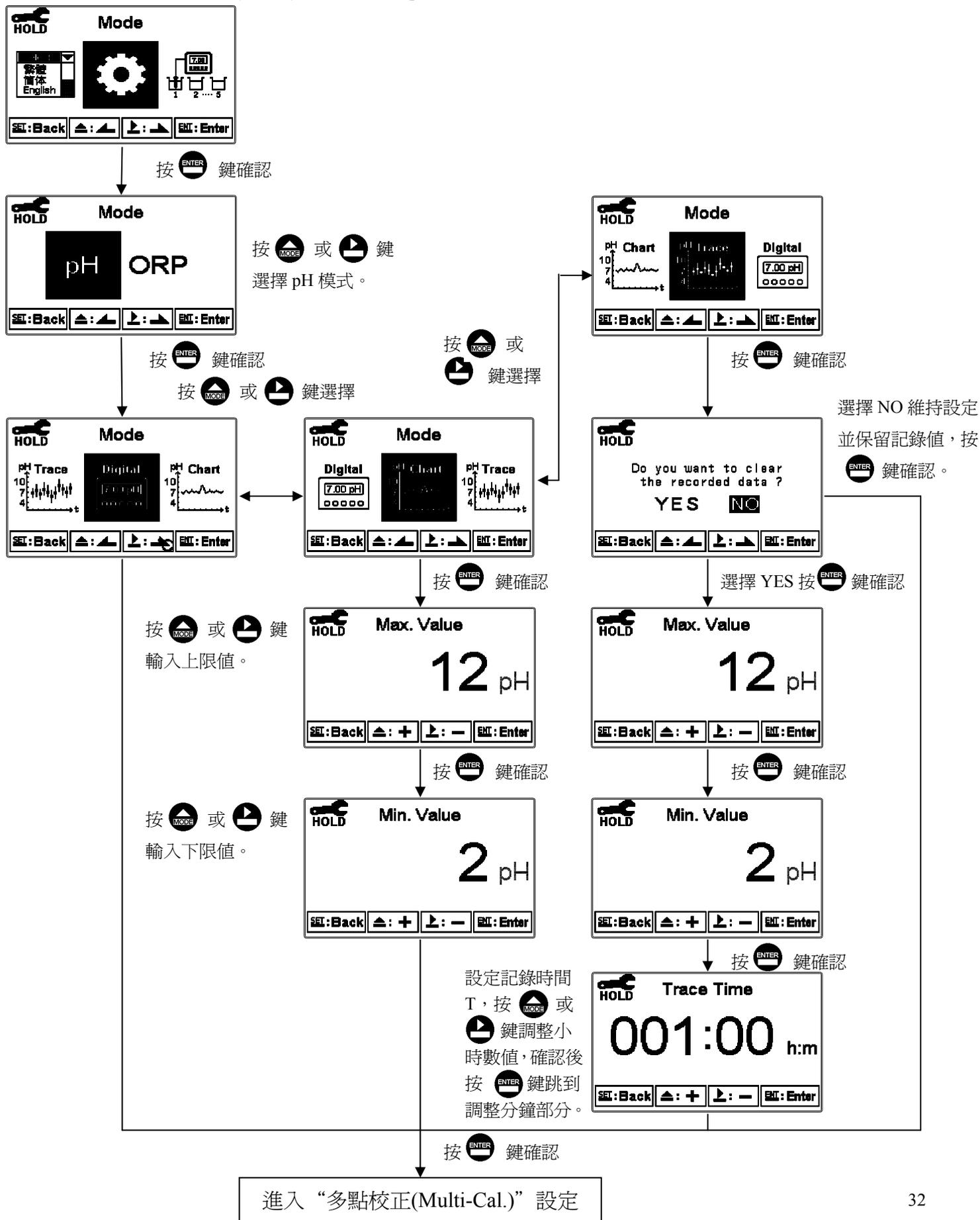
7.4.2 進入測量模式(Mode)設定，選擇 ORP 測量模式，並選擇測值顯示方式。
