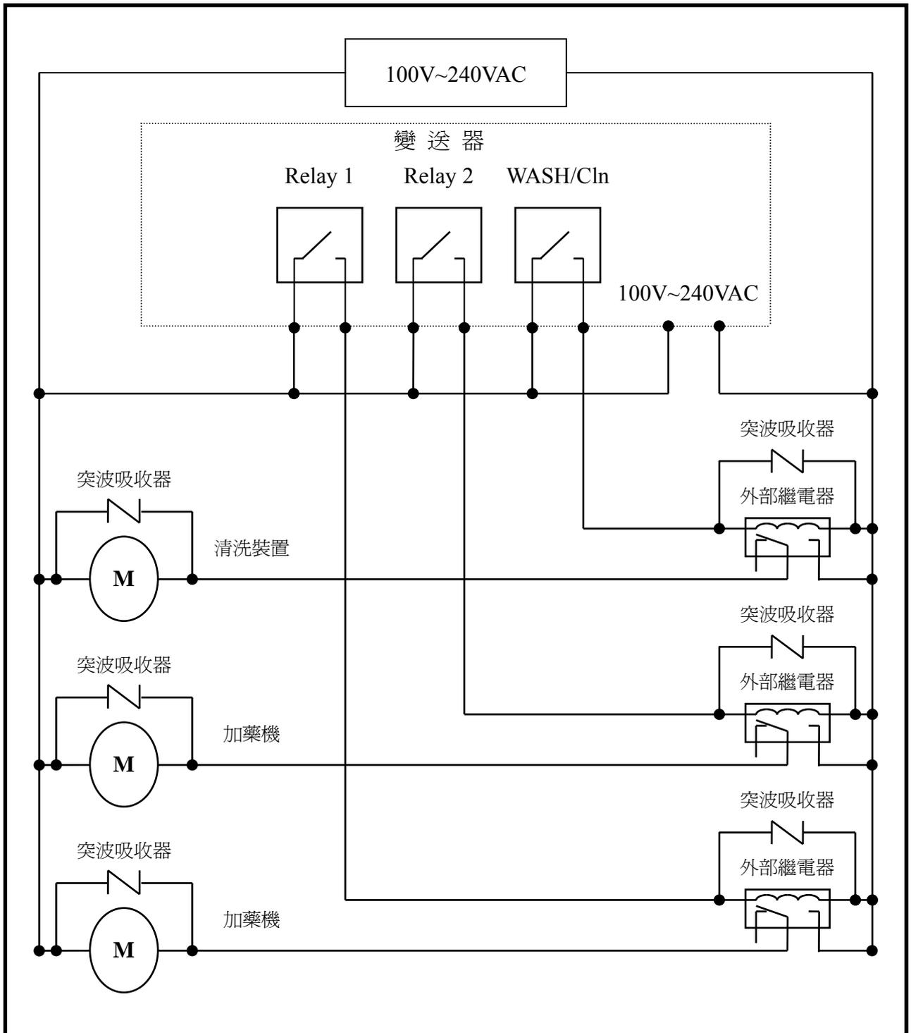
註：變送器內裝微型繼電器，需要技術人員才能維修更換，建議使用時外接大功率繼電器 (Power Relay)來驅動周邊設備。
