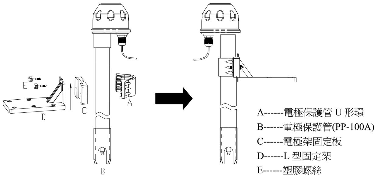
1. 將 (C) 電極架固定板套在 (D) L 型固定架上。
