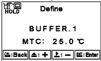
將電極用蒸餾水清洗乾淨，放入第一點標準液中。若溫度為 MTC 模式下，按 **MODE** 或 **RIGHT** 鍵調整溫度。
