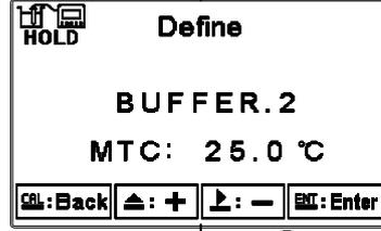
將電極用蒸餾水清洗乾淨，放入第二點標準液中。若溫度為 MTC 模式下，按 **MODE** 或 **RIGHT** 鍵調整溫度。若按 **CAL** 鍵則只做單點校正。
