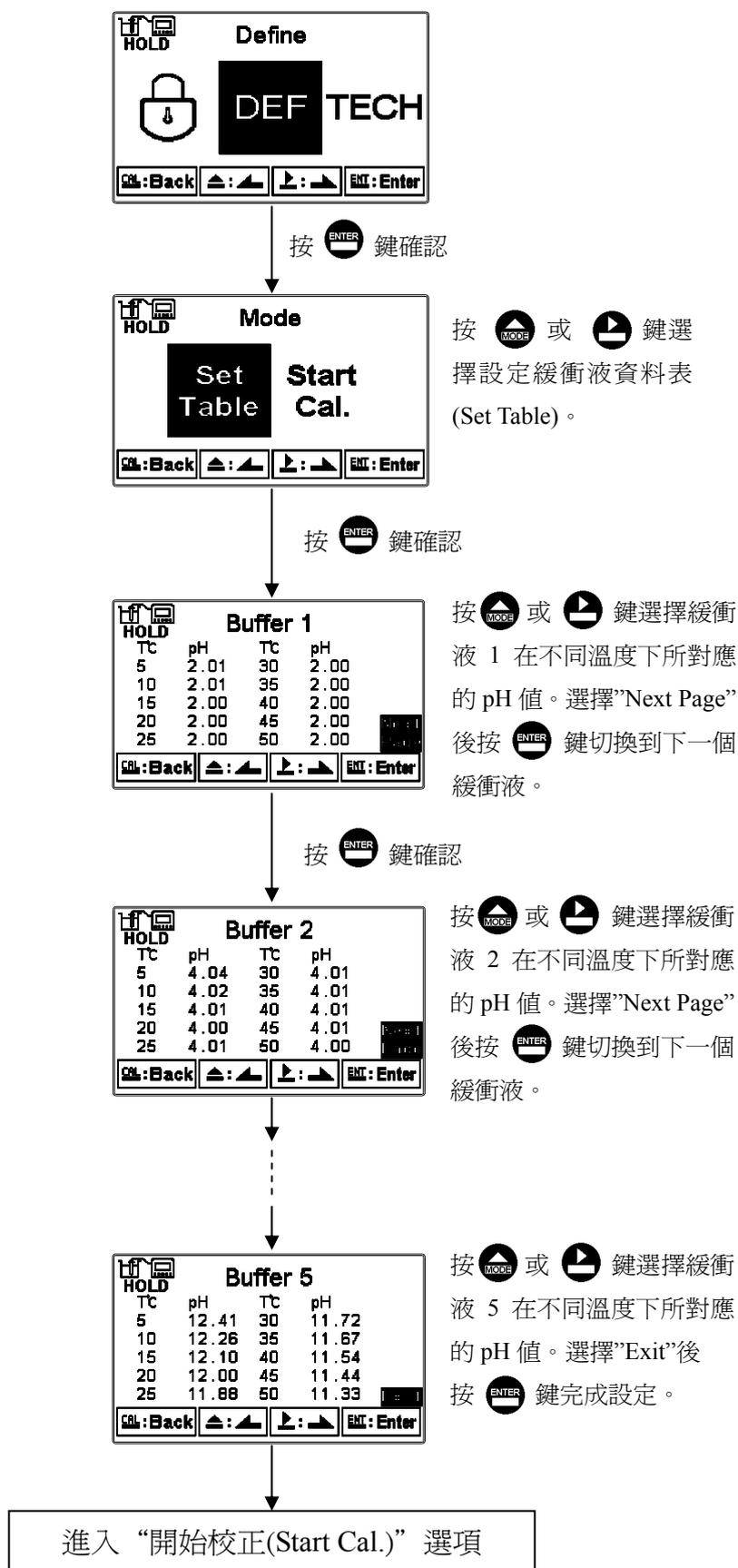
以下為在 Define 模式下做二點校正的流程。首先在參數設定模式下設定其校正點數為 2(請參考第 7.5 節多點校正)，之後再回到校正模式選擇 Define 模式，並依下列流程圖操作。
